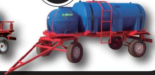
Acoplado Tanque 4500 Lts.
